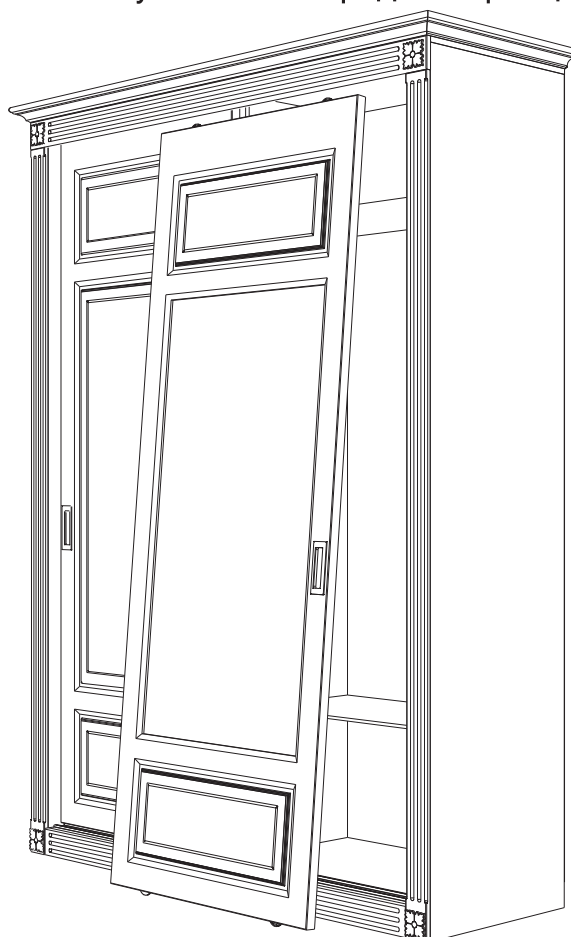
в. установка переднего фасада
