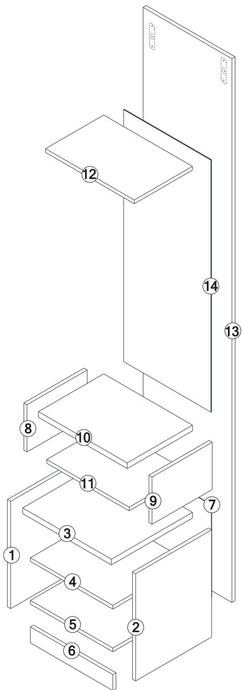
Зеркало крепится к задней панели с помощью фурнитуры "крепление к стене" с равными зазорами по краям; сверху и снизу (стр. 23).
